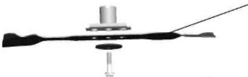
Vuelva a colocar todo en su lugar como se muestra. Apriete el tornillo correctamente. El par de apriete es de 45Nm. Cambie también el tornillo de la cuchilla cuando sustituya la cuchilla.
